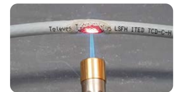
Prueba de fuego con un cable LSFH, donde vemos que no emite humos y minimiza la propagación de llamas.
