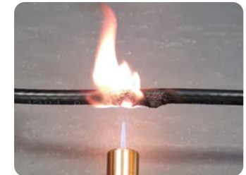
Prueba de fuego con un cable PVC, donde vemos que es más inflamable y emite humos.
